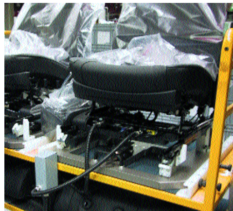
Bild 2: Die Datenleitung von der Prüfstation mündet in einem Druckgussgehäuse mit Magnetbefestigung, dem Gateway-Modul und den Anschlüssen für die Sitze.
