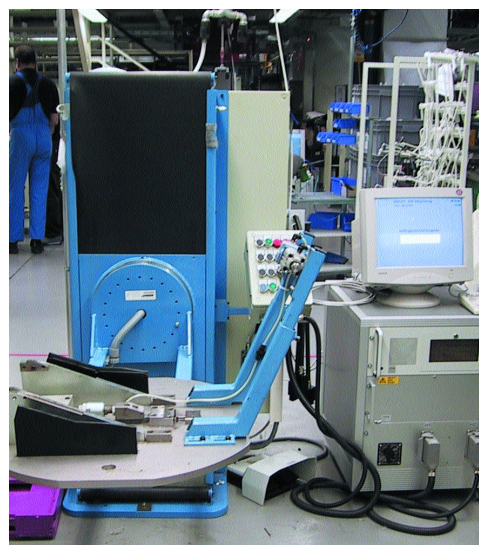
Bild 3: Für die als Sonderausstattung erhältlichen hinteren Einzelsitze gibt es separate Prüfstationen direkt nach der Montage.
