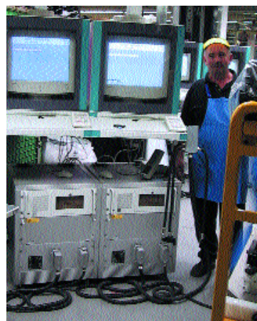
Bild 1: Die Ascot-Prüfstation in der Endkontrolle besteht aus zwei Einheiten, so dass sich die Vordersitze parallel kontrollieren lassen.
