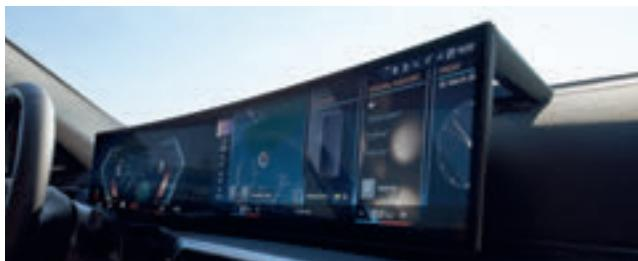
■ Das BMW Curved Display paart eine ergonomisch optimierte, intuitive Bedienung mit einem Anzeigenverbund aus 12,3" volldigitalem Instrumentendisplay und 14,9" Control Display. Letzteres lässt sich bequem per Touchscreen bedienen. Die freischwebend wirkende Optik und die geschwungene Form des BMW Curved Displays sorgen für eine elegante Anmutung.
