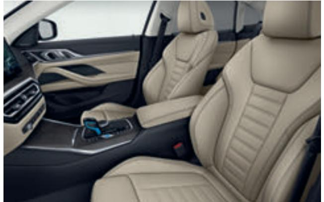
■ Die Sportsitze für Fahrer und Beifahrer bieten optimalen Seitenhalt durch höhere Sitzwangen und eine manuell einstellbare Oberschenkelauflage. Zudem lassen sich die Sitzlängsrichtung, -höhe und -neigung manuell verstellen.
