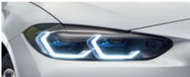
□ Das adaptive BMW Laserlicht leuchtet im Laser-Fernlichtmodus mit über 500 m nahezu doppelt so weit wie herkömmliche Scheinwerfer. Durch die bessere Sicht im Dunkeln wird so die Sicherheit deutlich erhöht. Blaue Akzente und der Schriftzug „BMW Laser“ im Scheinwerfer unterstreichen zudem den technologischen Anspruch und die Sportlichkeit des Fahrzeugs.
