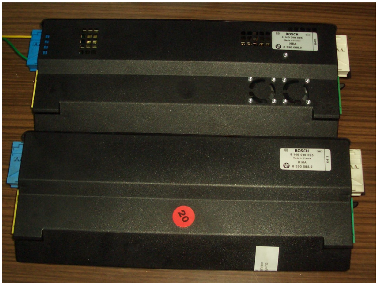
Oben: modifiziertes IHKA-Steuergerät Unten: originales IHKA-Steuergerät
